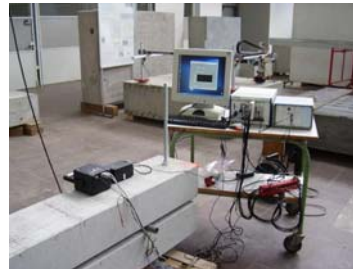
Abbildung 4 Messsystem „Multistatistisches Array“: Links: multistatistischer Array-Messkopf M3102, rechts: Messaufbau für Riss-Untersuchungen
