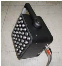
Abbildung 4 Messsystem „Multistatistisches Array“: Links: multistatistischer Array-Messkopf M3102, rechts: Messaufbau für Riss-Untersuchungen
