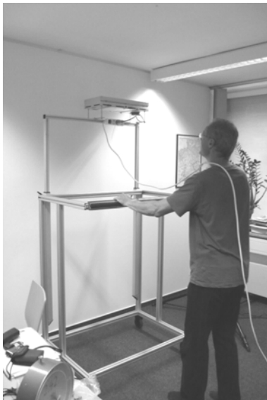
Abbildung 3: Erwärmung der Raumdecke durch den Infrarotstrahler
