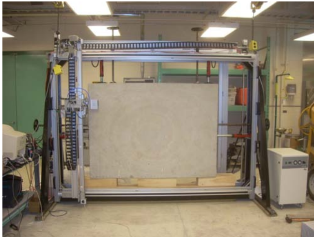
Abbildung 1: Teststand bestehend aus vollautomatisierten Scannersystemen, die an einem Stahlgestell befestigt sind . Der Probekörper wird von einem Gabelstapler im Stahlrahmen positioniert und über Hydraulikzylinder gehalten.
