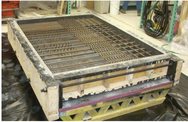
Abbildung 2: Probekörper mit Bewehrungsstahl unterschiedlichen Durchmessers, mit variierendem Abstand, in unterschiedlicher Tiefe und in mehreren Lagen (x- und y-Richtung).
