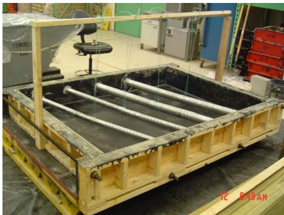
Abbildung 3: links: Schalung des Probekörpers mit Spannkanälen, die bereichsweise verpresst, unverpresst oder nur halb verpresst sind. rechts: Die Hüllrohre vor dem Einbau.
