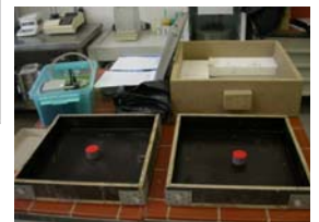
Vorbereitung der Prüfplatten mit Feuchtefunkfühlern
