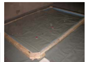
Kalibrierversuche in klimagelagerten Estrichprobekörpern mit Feuchtesensoren
