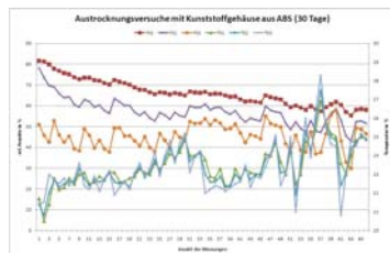
Nachweis und Vergleich der Wasserdampfdurchlässigkeit verschiedener Kunststoffgehäuse
