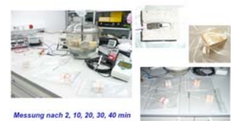
Kalibrierversuche in klimagelagerten Estrichprobekörpern mit Feuchtesensoren
