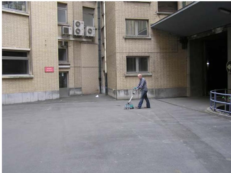
*Abb. 6 Feuchtescan auf asphaltierter Stahlbetondecke*
