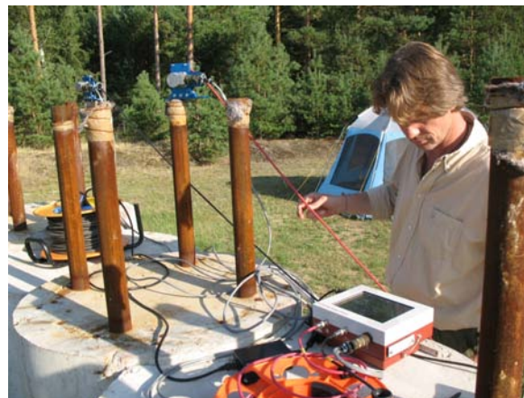
Abbildung 10: Messungen am Referenzprobekörper mit der Ultraschallmethode (CHAMP, PDI).
