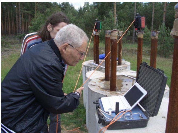
Abbildung 9: Messungen am Referenzprobekörper mit der Ultraschallmethode (CHUM, Piletest Ltd.).
