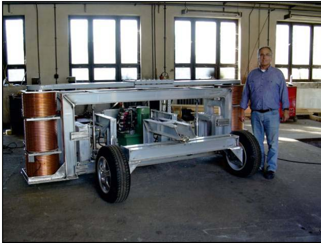
Abb. 5 Jochmagnet als Teil des Remanenzmagnetismusverfahrens
