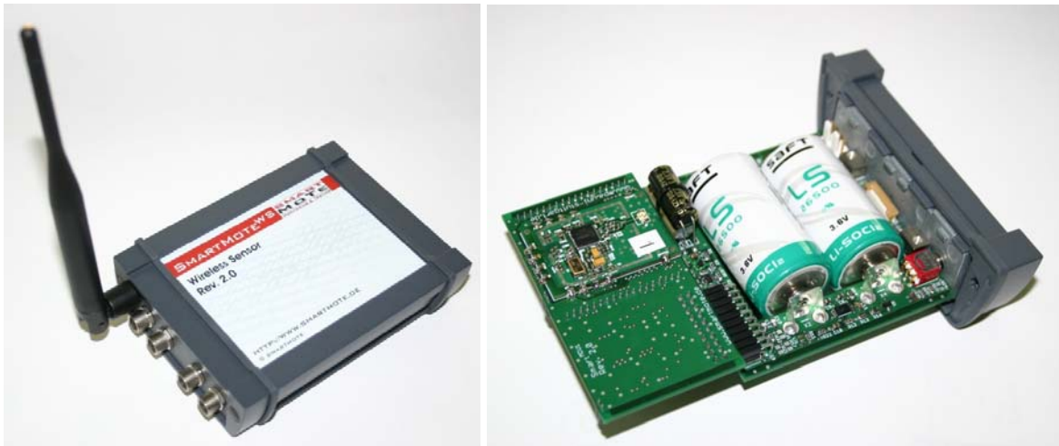
Abbildung 3: Sensorknoten für den Betrieb in drahtlosen Sensornetzen (links) mit Stromversorgung und Miniatursensoren (rechts).
