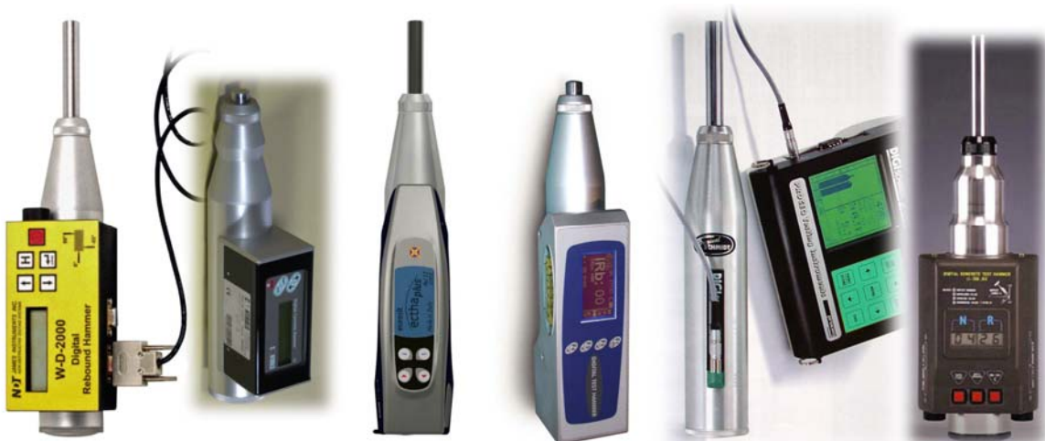
Abbildung 1. Eine Auswahl „Digitaler“ Schmidt Hämmer mit externer Anzeige oder mit Huckepack
