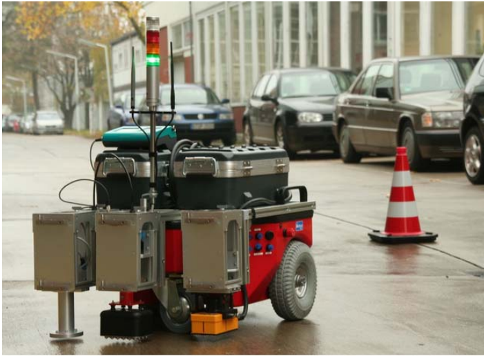
Abbildung 1: Betoscan Plattform zur automatisierten Messung von Parkdecks
